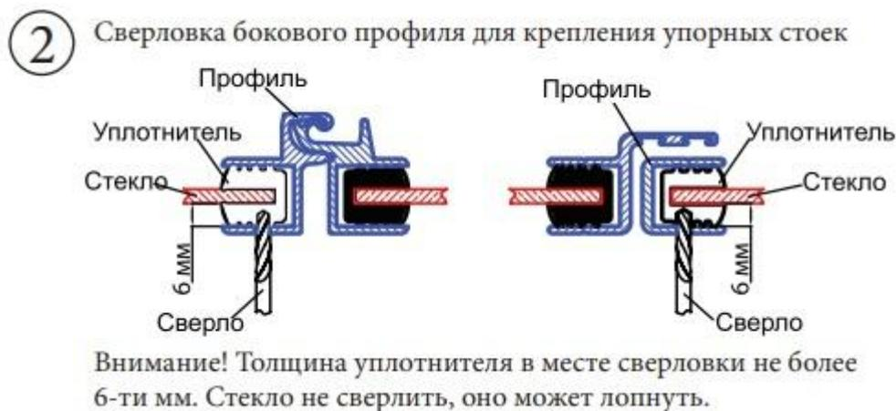
18. Упорные стойки устанавливаются, так чтобы обеспечить оптимальную геометрию створа калитки.
